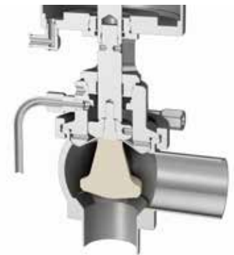
Variante mit PEEK-Teller A370D-PEEK
