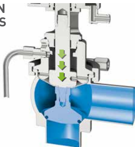
Hermetische Barriere verhindert den Fahrstuhleffekt
