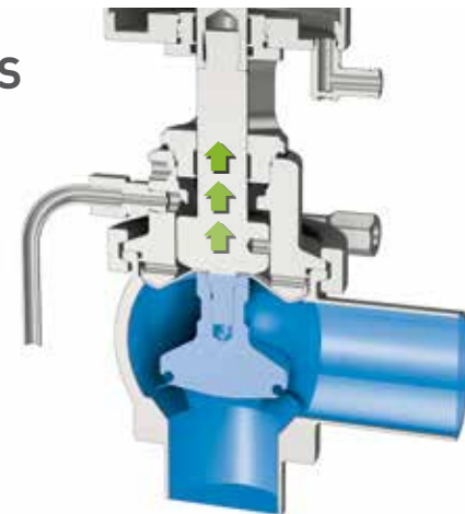
Hermetische Barriere verhindert den Fahrstuhleffekt
